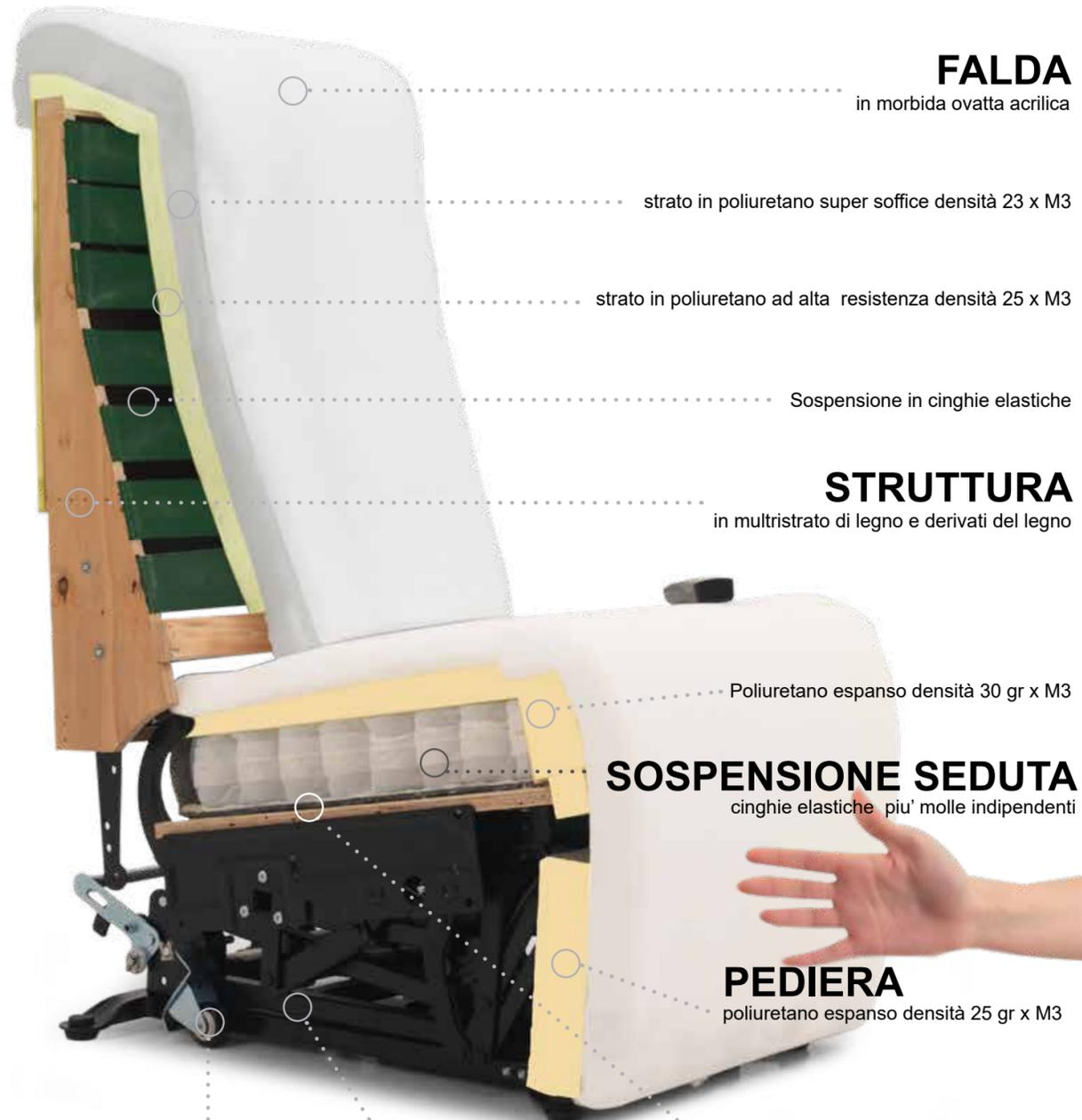
L'innovativa seduta **AIR-System\*** è un sistema che crea una circolazione di aria al suo interno durante il normale utilizzo di compressione e decompressione grazie alle molle in acciaio (foto A) rivestite in tessuto e alle fessure laterali (foto B) questo sistema offre una serie di vantaggi molto importanti:
